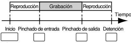
En el MICRO BR, puede elegir entre dos métodos para hacerlo; el pinchado de entrada/salida manual y el pinchado de entrada/salida automático.
