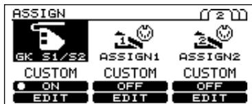
3. Presione [F2] para encender/apagar la función Assign.
