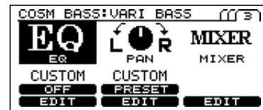
\* PRESET es un ajuste recomendado para cada sección. Por ejemplo, los PRESETs para la sección BODY en el VARI BASS serán VIOLIN, SEMI-HLW, y HUGE WD. No hay PRESET para las secciones sin icono "PRESET", "ON", o "OFF".
